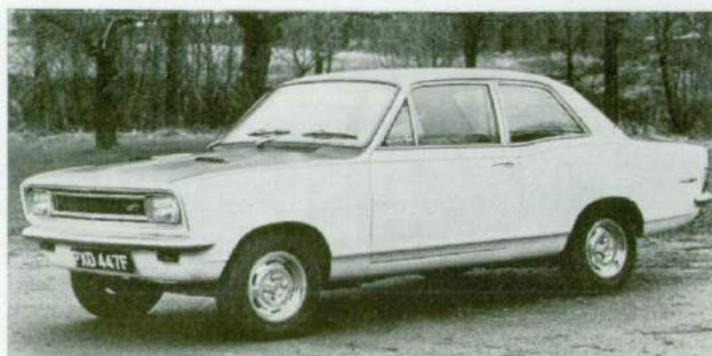
Versione «spinta» della Viva, la «1200» costruita dalla filiale inglese della General Motors. Per la versione GT, motore di 2000 cmc e velocità massima sui 160 km/h.
