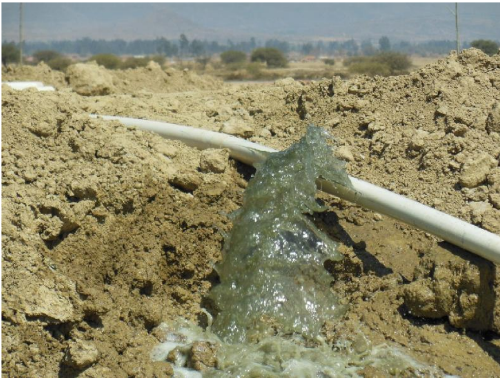
Photos: A103 y 104.- Ruptura de los tubos de riego y perdida del agua
